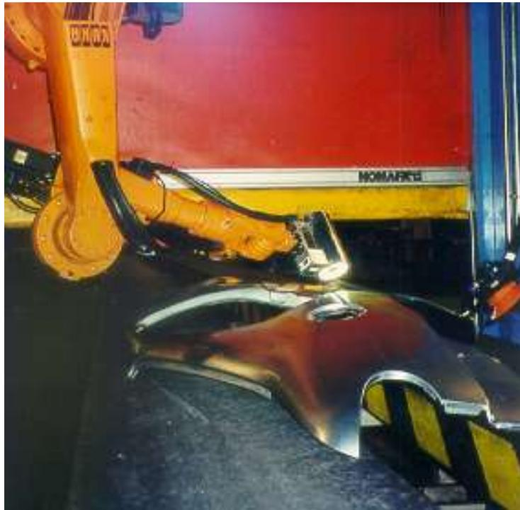
**Figura:** Las posiciones de las cámaras son normalmente fijas pero también existen sistemas de inspección que incorporan algún mecanismo para desplazar las cámaras. En la figura se muestra un sistema para la inspección de grandes piezas de chapa estampada en el que un robot desplaza la cámara a las distintas zonas a inspeccionar.
