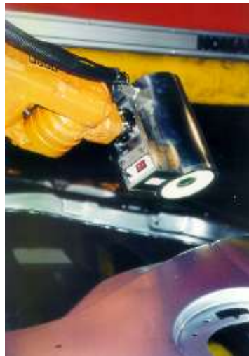
Figura 7 Fluorescente circular embarcado en un robot para la inspección de chapa embutida
