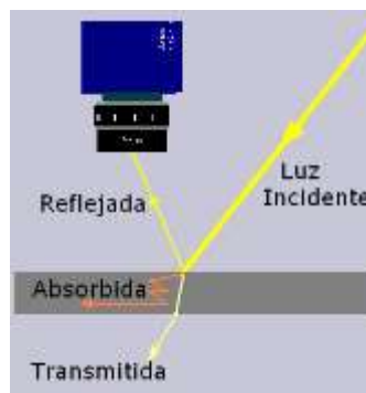
Figura 2. Al incidir un rayo de luz sobre la superficie de un material este se divide en como mucho en tres componentes: una parte que se refleja, otra que es absorbida por el material y otra que le atraviesa y es transmitida de nuevo al medio.
