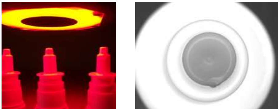
Figura 5 Patrón anular en una aplicación de inspección de válvulas para farmacia. Imagen obtenida con esa iluminación donde se puede apreciar claramente un fallo en la circularidad.
