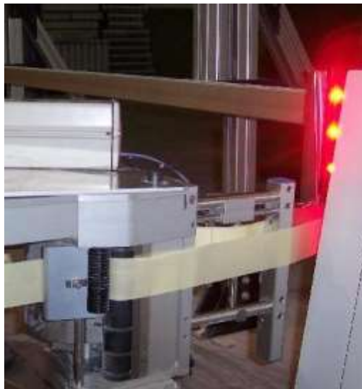
Figura 8 Fuente de iluminación LED
