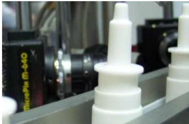
Figura 2: Con el abaratamiento de las cámaras y el aumento de la potencia de cálculo de los procesadores son frecuentes los sistemas multicámara que permiten inspeccionar varias facetas del producto.
