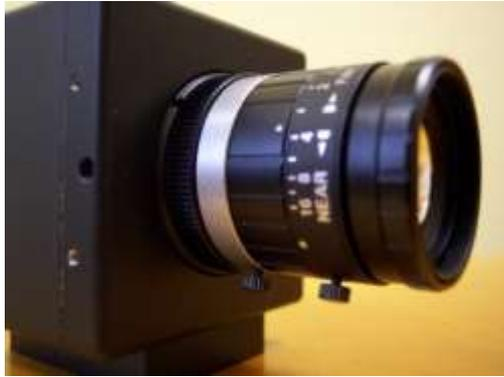
Figura 5: En aplicaciones industriales, donde es especialmente importante la robustez mecánica, las lentes deben presentar tornillos para fijar el enfoque, iris o zoom una vez que ya han sido ajustadas.
