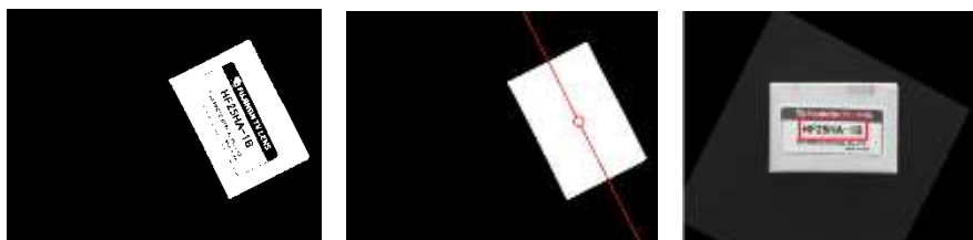
Figura 4.27. a) Imagen binaria. b) Imagen de la caja sin agujeros. Sobre la imagen aparecen sobreimpresionados el centro de gravedad y la orientación. c) Imagen resultante de la rotación donde se ha marcado la ROI.
