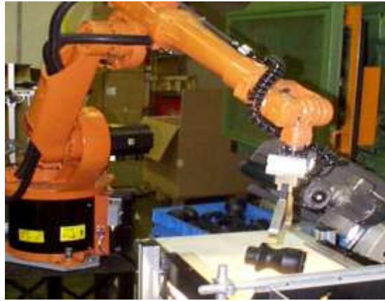
Figura 4.4. Muchas aplicaciones de guiado de robots operan sobre imágenes binarias. Las imágenes binarias contienen toda la información referente a la silueta del objeto y por tanto de ellas se puede extraer rápidamente la localización y orientación del objeto a capturar.
